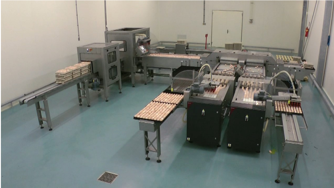
Clasificadora huevos fértil 20.000 hora Tipo Elgra 4 con 2 embaladoras para todo tipo de alveolos
